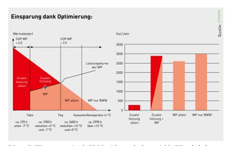
Solange die Wärmepumpe wirtschaftlich betrieben werden kann, wird der Wärmebedarf grösstenteils mit Umweltenergie gedeckt. Sobald die Aussentemperatur und damit der «Coefficient of Performance» (COP) der Wärmepumpe aber unter einen definierten Wert fällt, setzt die Zusatzheizung ein.
