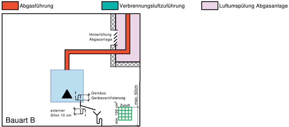
Falls Entwässerung nicht über Gerät erfolgt, dann zusätzlicher Siphon einbauen. Der Siphon muss kontrolliert und gewartet werden.
