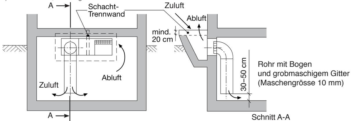
Im Lüftungsschacht ist zur Verhinderung eines Kurzschlusses zwischen Aussenluft- und Abluftöffnung eine Trennwand aufzuziehen, die die Schachtoberkante um mindestens 20 cm überragt. Anstelle einer Trennwand könnte auch die Abluft mittels eines Rohres entsprechend über Terrain geführt werden. Die Öffnung ist gegen Wassereintritt zu schützen.
