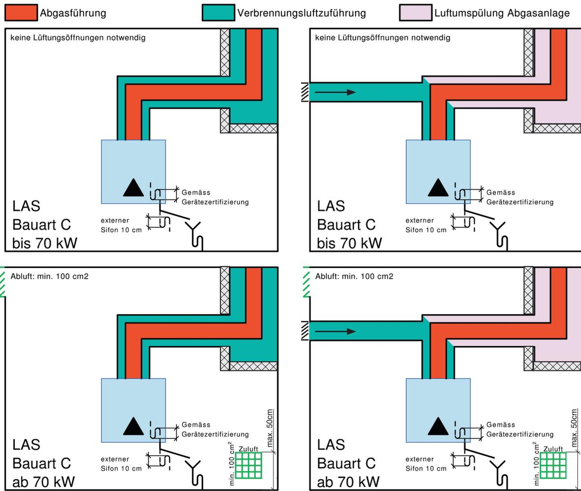
Falls Entwässerung nicht über Gerät erfolgt, dann zusätzlicher Siphon einbauen. Der Siphon muss kontrolliert und gewartet werden.
