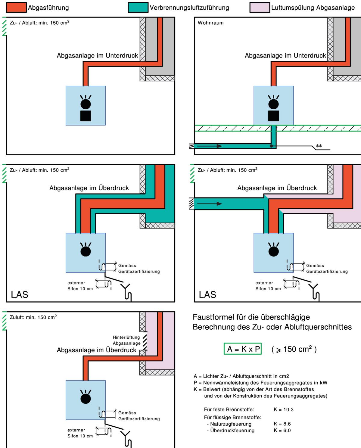
Falls Entwässerung nicht über Gerät erfolgt, dann zusätzlicher Siphon einbauen. Der Siphon muss kontrolliert und gewartet werden.
