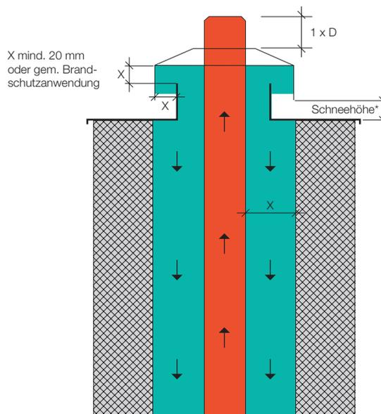
\*Je nach Lage und Ort muss die Schneehöhe entsprechend berücksichtigt werden. Ist die Heizungsanlage ständig in Betrieb und kann davon ausgegangen werden, dass sich aufgrund der Auflagefläche an der Mündung kein Schnee ansetzt, so kann die Schneehöhenanforderung vernachlässigt werden. (Brandschutzniveau beachten)
