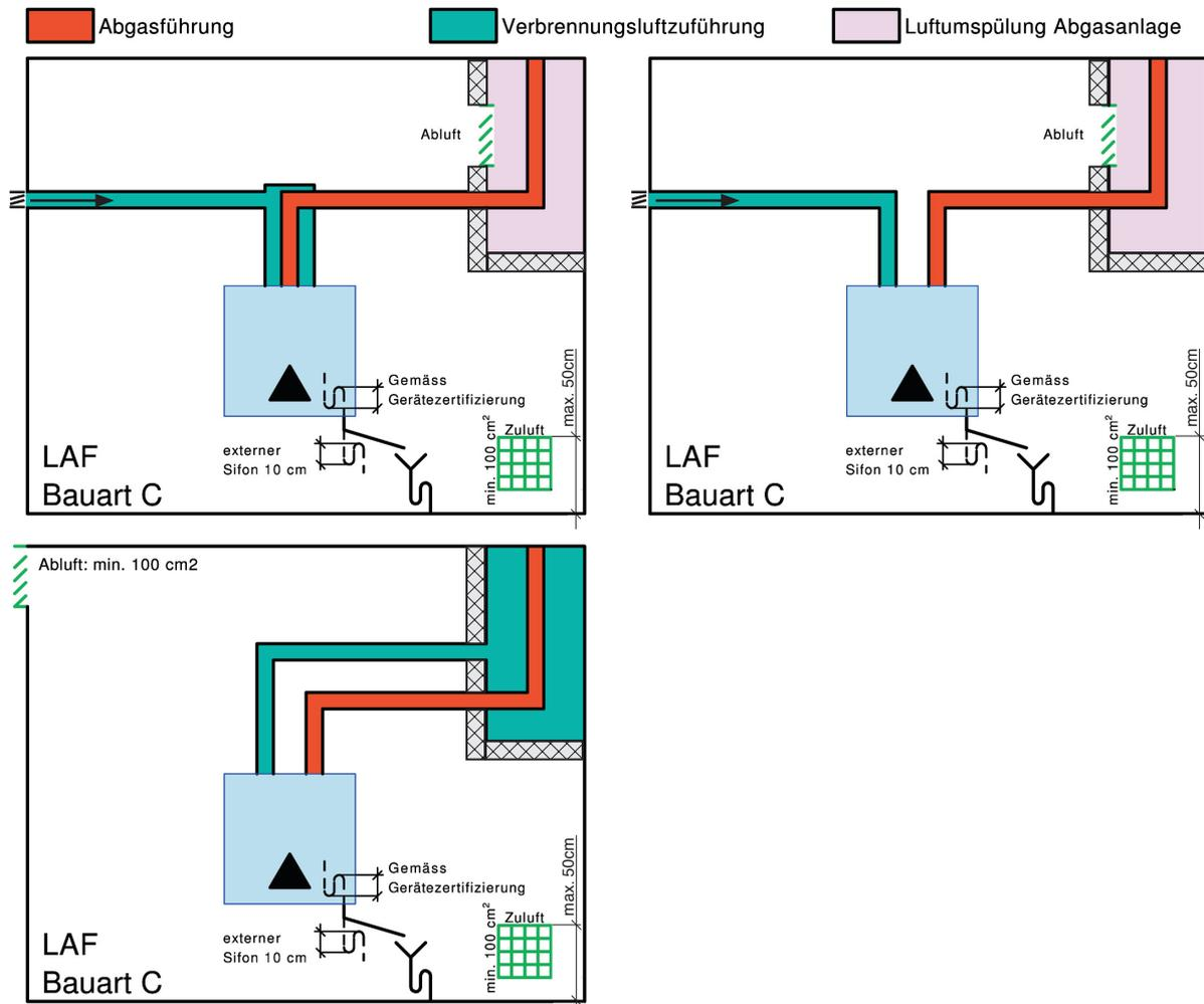
Falls Entwässerung nicht über Gerät erfolgt, dann zusätzlicher Siphon einbauen. Der Siphon muss kontrolliert und gewartet werden.
